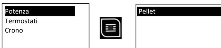
All'interno del sotto menù Potenza è possibile regolare, appunto, la potenza di combustione
