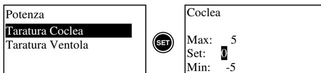
Consente di adattare il funzionamento della caldaia alle varie tipologie di pellet (qualità pezzatura ecc.); con una singola regolazione si corregge la portata del pellet in tutte le potenze di funzionamento.
