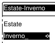
Consente di Impostare la modalità Estate (solo produzione di Acqua Sanitaria, nel caso in cui è installato un boiler per la produzione della stessa) o Inverno (Riscaldamento e produzione di Acqua Sanitaria).
