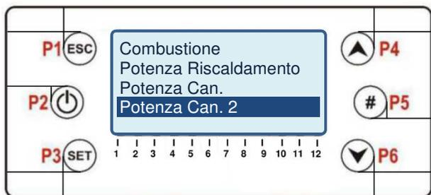
Tramite i tasti freccia ▲ ▼ e la pressione del tasto SET è possibile selezionare il sottomenù Potenza Canalizzazione 2.
