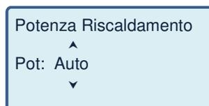
Permette di regolare la velocità del Ventilatore aria calda installato a bordo del termocamino. Con la pressione dei tasti freccia ▲ ▼ è possibile selezionare fra la potenza manuale scegliendo da 1 a 6, oppure la modalità di potenza automatica. Per uscire premere il tasto ESC.
