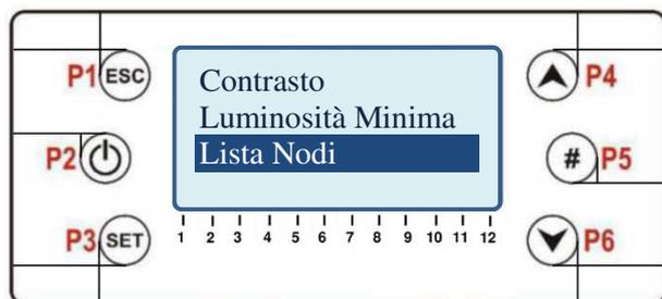
Tramite la pressione del tasto SET è possibile selezionare il sottomenù Lista Nodi.
