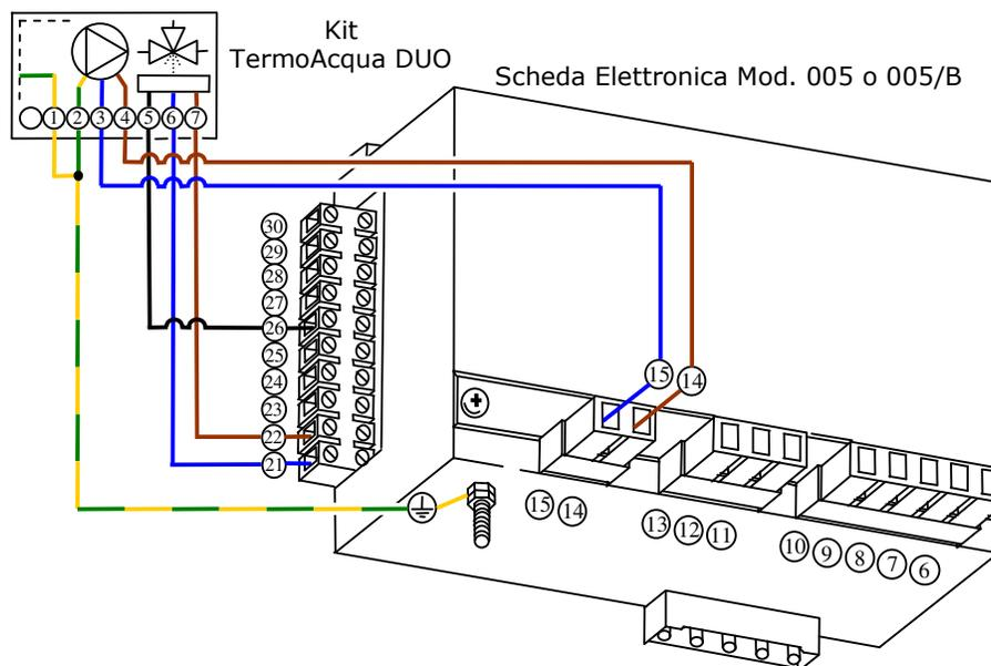
**Collegamento elettrico alla centralina elettronica del Termocamino della serie Energy:**
