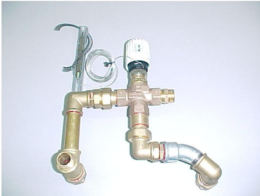
Dispositivo che permette di mantenere la temperatura dell'acqua in caldaia sempre sopra i 60°C e quindi limitare fortemente i fenomeni di condensa.
