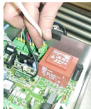
all'estremità del cavetto di collegamento e collegare le due cordicelle dello stesso cavetto nei morsetti **61** e **62** (contraddistinti dalla dicitura "**CONSENSO DA MODEM GSM**") della morsettiera esterna a 6 poli della centralina elettronica della stufa.
