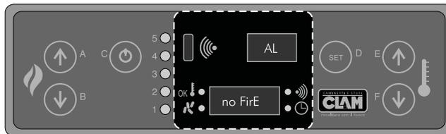
**Funzione del termostato di sicurezza** : quando la temperatura delle pareti del serbatoio del pellet diventa troppo elevata questo dispositivo interrompe l'alimentazione del pellet. Anche questa anomalia non viene segnalata dal pannello di controllo, ma la stufa si andrà progressivamente spegnendo e raffreddando; quando la temperatura dei fumi sarà scesa al di sotto di 60 °C il display del pannello di controllo riporterà la scritta **"AL" "no FirE"**.
