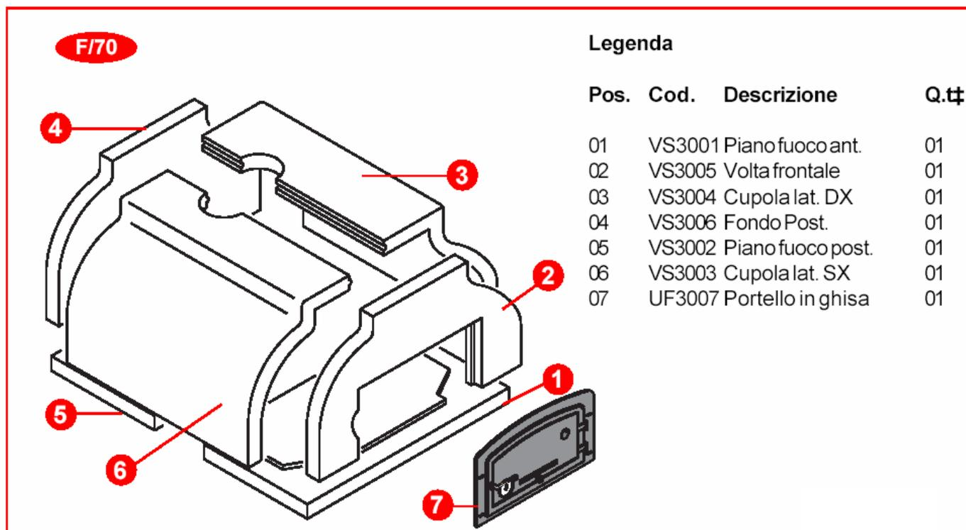
La numerazione delle istruzioni di montaggio, vale esclusivamente come ordine di posa dei vari elementi durante la fase di assemblaggio.
