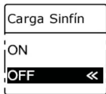
Permite, con la estufa en el estado apagado, efectuar la carga del tubo de transporte de pellets en la cámara de combustión.
