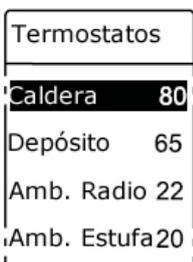
Dentro del menú termostatos está el termostato caldera, el termostato Depósito (visible solo si se ha instalado un acumulador de inercia o un depósito de agua caliente sanitaria conjuntamente), el termostato ambiente radio y el termostato ambiente estufa.
